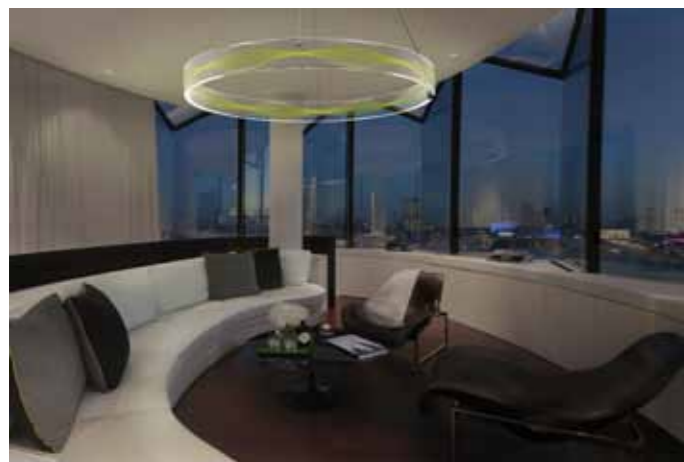
Abb.: Bei Leuchte »Cern« entstehen die feinen, lichtleitenden Linien durch eine Verletzung der Acrylglas-Oberfläche. Ihre transparente Anmutung behält sie auch, wenn die LED-RGB in den farbigen Modus schalten. (Foto: Sattler)
